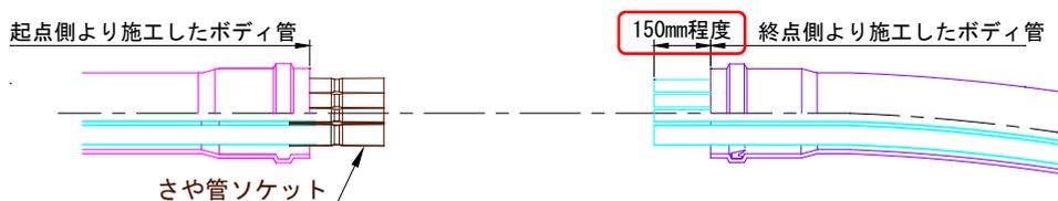
・メソケット付き調整さや管長さは以下の式により計算する。
